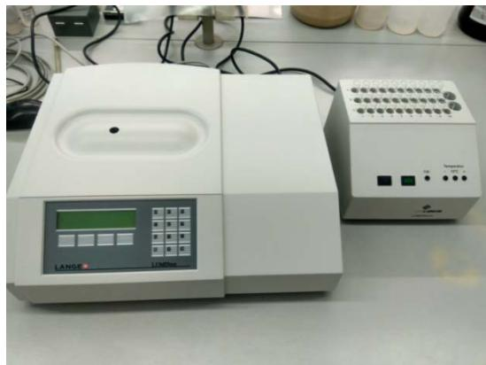
**Slika 27.** Luminometar i termostatirani blok, HACH LANGE, LUMIStox 300
