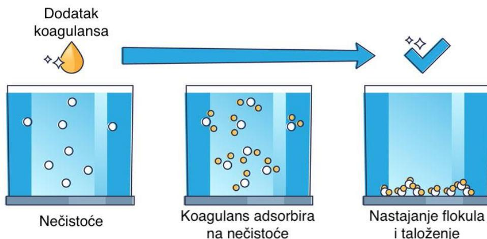
Slika 3.9 Prikaz procesa koagulacije/flokulacije.<sup>[33]</sup>
