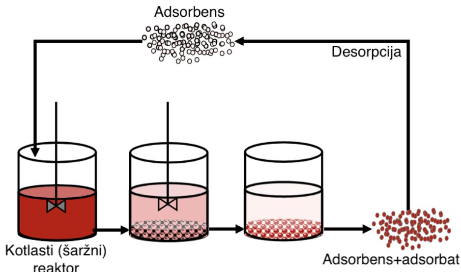
Slika 3.3 Adsorpcija unutar kotlastog reaktora.<sup>[7]</sup>
