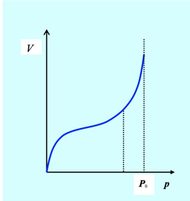
Slika 2.10 Grafički prikaz B.E.T. adsorpcijske izoterme.<sup>[2]</sup>
