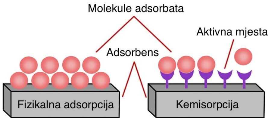
Slika 2.5 Prikaz višemolekularnog sloja nastalog fizikalnom adsorpcijom (lijevo) i monomolekularnog sloja nastalog kemisorpcijom (desno).<sup>[9]</sup>
