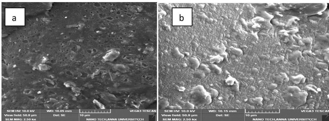
Slika 4.4 Fotografija površine nanočestica kitozana dobivena pretražnim elektronskim mikroskopom (SEM).<sup>[46]</sup>
