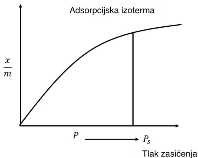
Slika 2.6 Grafički prikaz osnovne adsorpcijske izoterme.<sup>[12]</sup>
