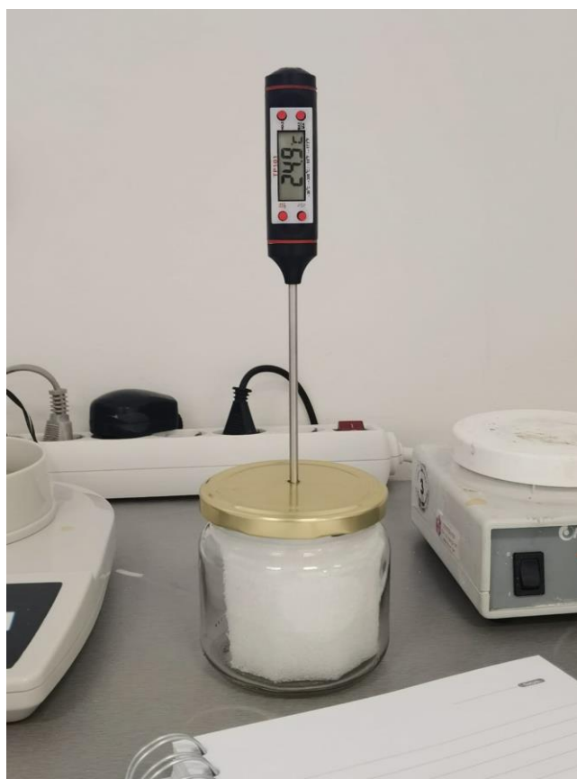
Slika 10. Mjerenje temperature uzorka u izoliranom sustavu
