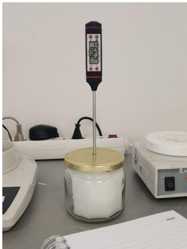
Slika 10. Mjerenje temperature uzorka u izoliranom sustavu
