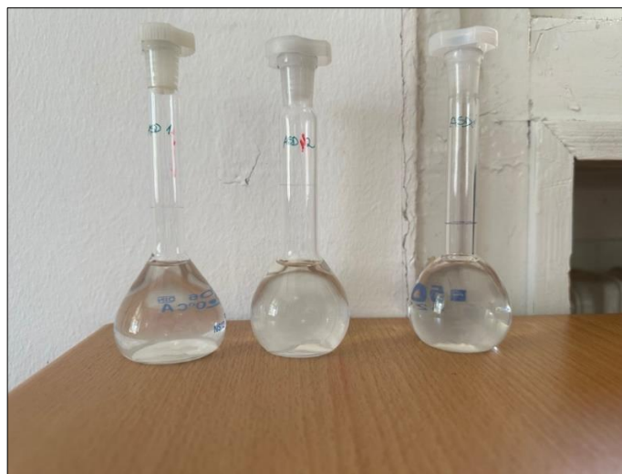
Slika 4.7. Pripremljeni uzorci čvrste disperzije djelatna tvar X-PVP otopljene u CH_3OH
