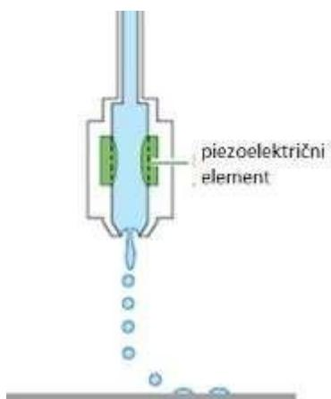
Slika 4. Princip inkjet ispisivanja<sup>[17]</sup>.
