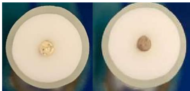
Slika 5. Prikaz srebrne(Ag) elektrode prije i nakon kloriranja.
