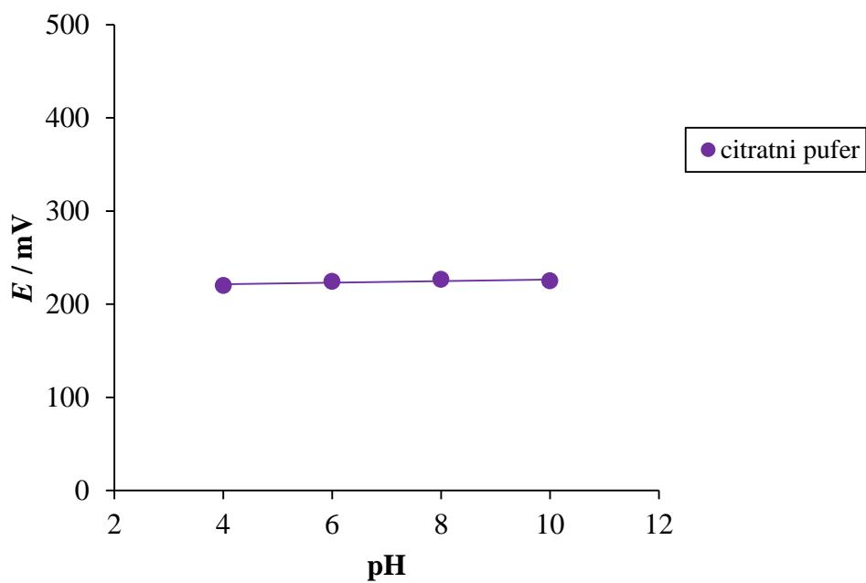
Slika 15. Ispitivanje utjecaja pH na odziv elektrode GC-RM2-EtOH.
