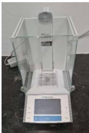
Slika 5. Analitička vaga Mettler Toledo XA105 DualRange
