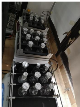
Slika 3.6. Postavljene tikvice za provedbu pokusa biorazgradnje PS-a.
