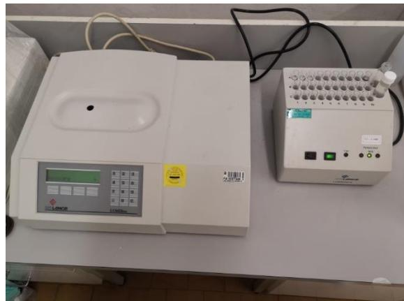
**Slika 3.4.** Luminometar LUMISTOX 300 i termometar LUMITHERM, Hach-Lange Gmb
