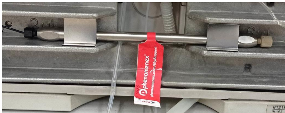
Slika 16. Kromatografska kolona Kinetex C18, tvrtke Phenomenex
