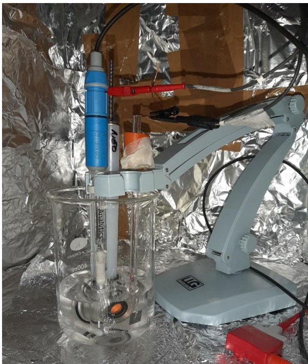
Slika 29. Elektrokemijska ćelija sastavljena od referentne elektrode (lijevo), radne elektrode (sredina) te pomoćne elektrode (desno).
