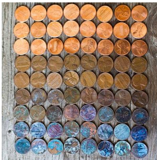
Slika 6. Oksidni sloj i patina na površini bakra. 11
