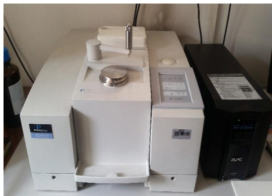
Slika 29. FTIR-ATR spektrofotometar Spectrum One, Perkin Elmer
