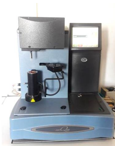
Slika 30. Termogravimetar Q500 tvrtke TA Instruments
