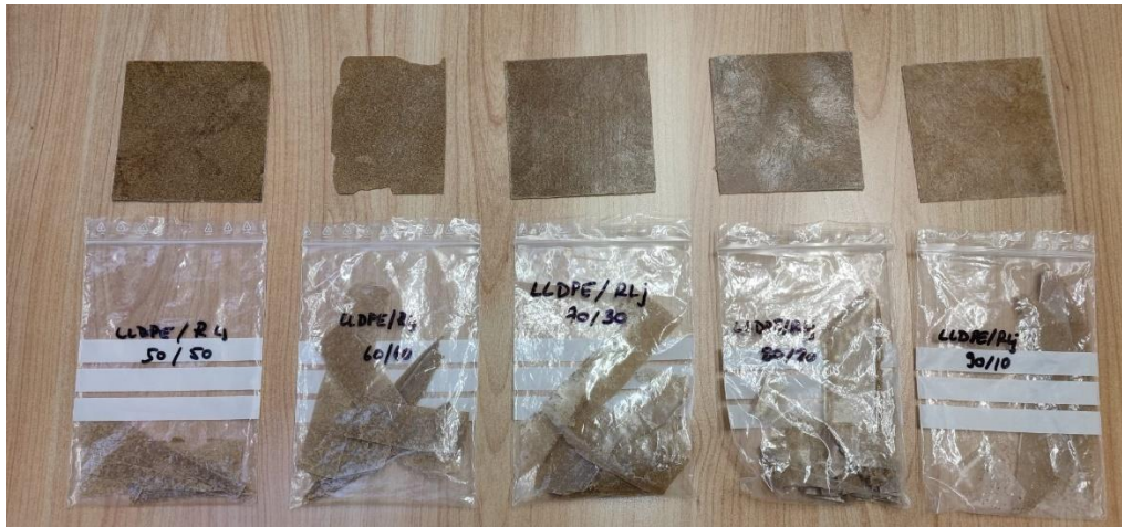
Slika 24. Biokompoziti LLDPE/RLJ s različitim udjelom RLJ
