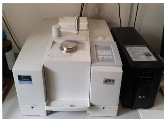
**Slika 28. FTIR-ATR spektrofotometar Spectrum One, Perkin Elmer**
