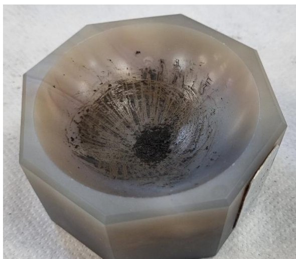
Slika 6. Homogeniziran uzorak u ahatnom tarioniku
