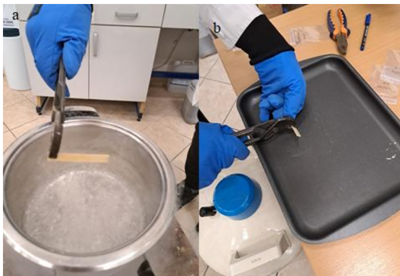
Slika 26. Tijek pripreme uzoraka za snimanje SEM-om; a) smrzavanje materijala tekućim dušikom, b) kidanje materijala kliještima
