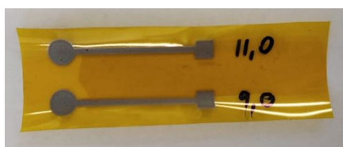
Slika 11. Inkjet ispisana srebrna elektroda, prije daljnje obrade.
