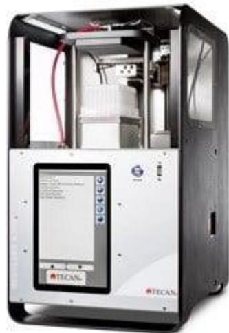
*Slika 18. Prikaz robotske konfiguracije Resolvex A-200*
