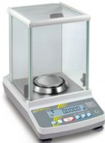
Slika 18. Fotografija analitičke vage KERN ALJ 220-4NM (KERN, Balingen, SR Njemačka)
