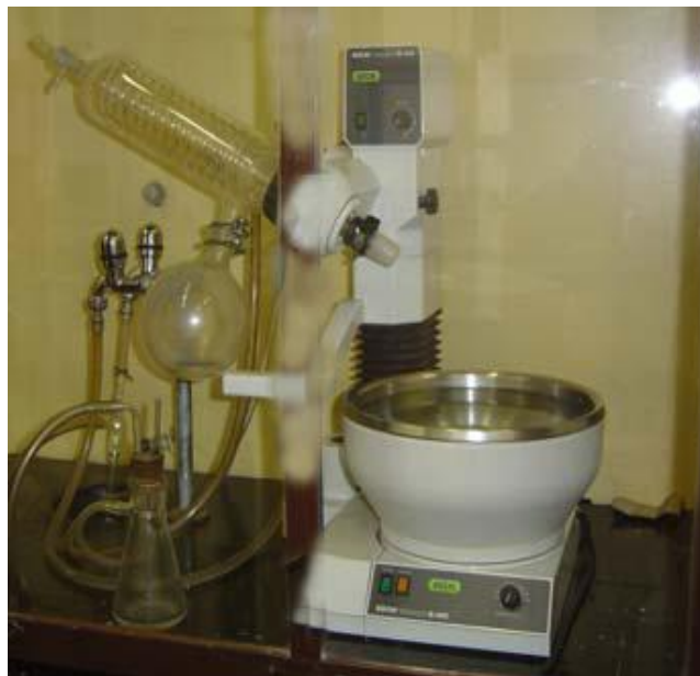
Slika 3.2. Rotirajući uparivač otapala R-114/A, Büchi, Švicarska
