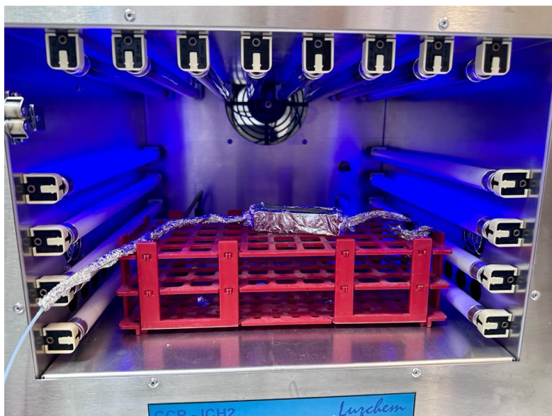
Slika 49. Provedba fotokemijske reakcije u fotokemijskom reaktoru pri valnoj duljini 365 nm.
