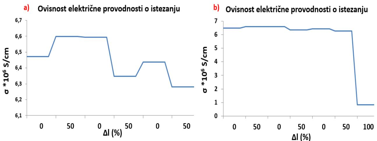
**Slika 61.** Grafički prikaza ovisnosti električne provodnosti o istezanju: a) uvećani prikaz pri 50 % istezanja b) Prikaz u cijelosti.
