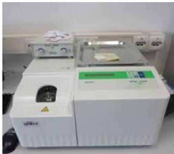
Slika 36. DSC uređaj Mettler Toledo 823eT.
