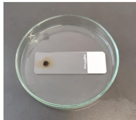
**Slika 39.** Priprema uzorka graft kopolimera za test umrežavanja.
