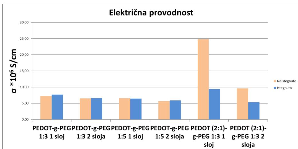
**Slika 59.** Prikaz vrijednosti električne provodnosti za neistegnuti i istegnuti uzorak pri 50 %.
