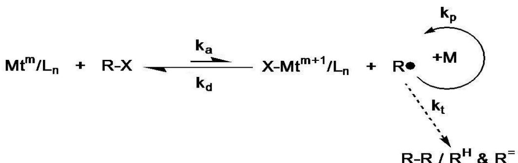
**Slika 20.** Mehanizam radikalske polimerizacije prijenosom atoma [22].
