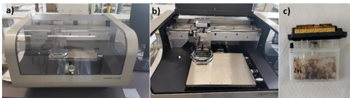
**Slika 37.** a) ispisni uređaj b) unutrašnjost uređaja c) spremnik s tintom
