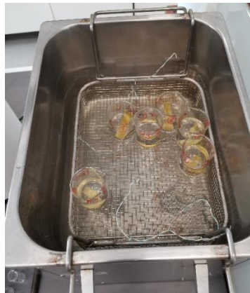
Slika 38. Ispitivanje adhezije uzoraka ultrazvučnom kupelji.
