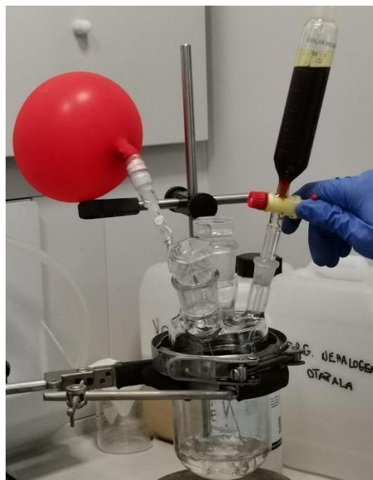
**Slika 29.** Sinteza PEDOT-Br makroinicijatora.
