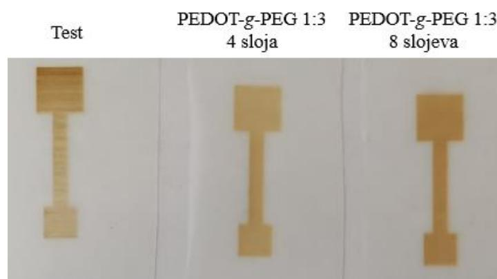
**Slika 54.** Ispisani slojevi testnog uzorka i graft kopolimera PEDOT-g-PEG 1:3.
