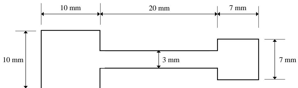
**Slika 53.** Prikaz dimenzija ispisane elektrode.
