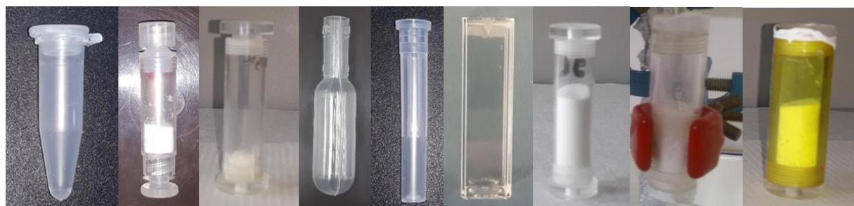
**Slika 54.** Korištene kolone u radu: eppendorf kiveta, Supelco kolona, kolona s tankom stijenkama (0,5 mm), plastična pipeta, kanila od igle, kiveta DLS, polikarbonatna kolona PC (debljina stijenke 1 mm), PC (debljina stijenke 2 mm). Slika je povezana sa **Tablicom 13**.
