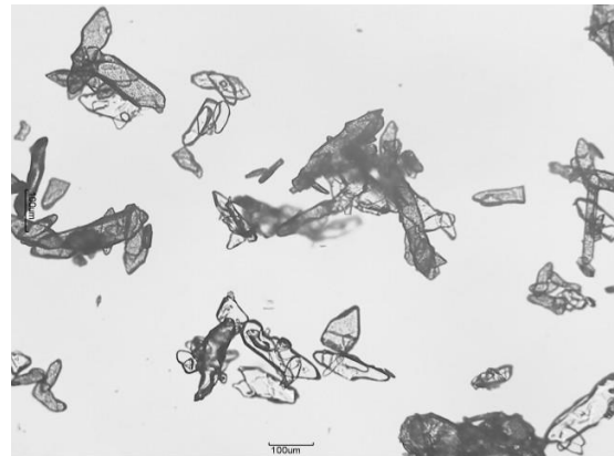
Slika 27. Fotografije kristala memantin hidrogen sulfata za sustav 2-propanol / n-heptan (75/25): a) brzo dodavanje n-heptana i b) dokapavanje n-heptana (uvećanje 100x)
