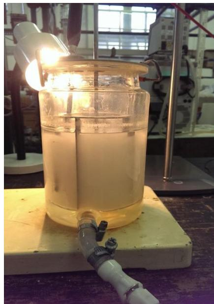
*Slika 11.* Kristalizator korišten u procesu šaržne kristalizacije hlađenjem
