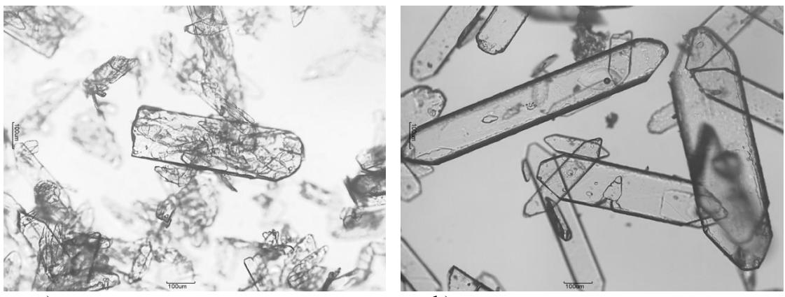
*Slika 26.* Fotografije kristala memantin hidrogen sulfata za sustav 2-propanol / etilacetat (75/25): a) brzo dodavanje EtOAc i b) dokapavanje EtOAc (uvećanje 100x)
