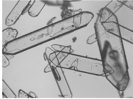
Slika 26. Fotografije kristala memantin hidrogen sulfata za sustav 2-propanol / etilacetat (75/25): a) brzo dodavanje EtOAc i b) dokapavanje EtOAc (uvećanje 100x)
