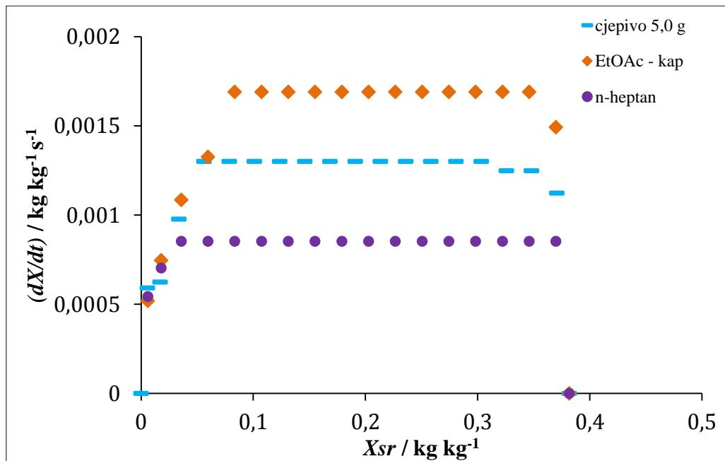
*Slika 33.* Brzina sušenja kristala memantin hidrogen sulfata za sustave: sa dokapavanjem etilacetata, brzim dodatkom n-heptana i cjeplivom 5,0 g
