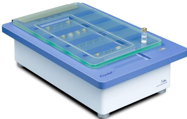
*Slika 10 .Crystall16* uređaj za određivanje širine metastabilne zone
