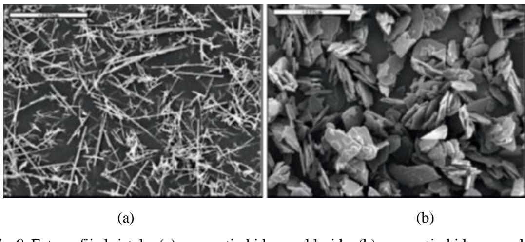
*Slika 9.* Fotografije kristala: (a) memantin hidrogen klorida; (b) memantin hidrogen sulfata
