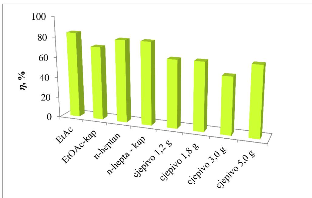
Slika 34. Iskorištenja procesa šaržne kristalizacije memantin hidrogen sulfata
