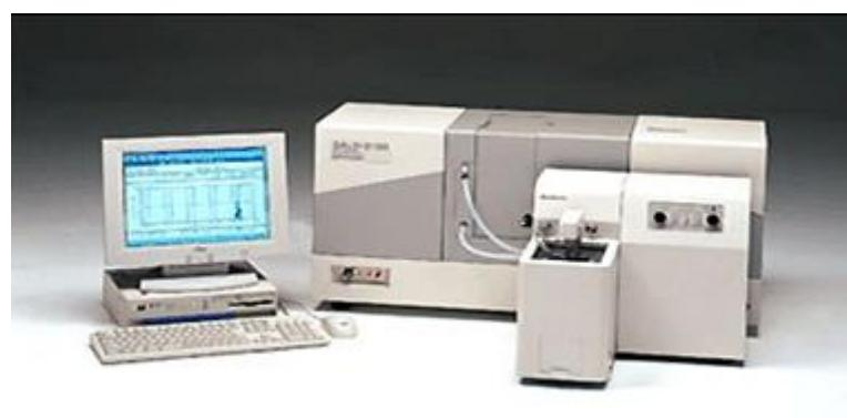
*Slika 14.* Čestični analizator *Shimadzu sald 3101*
