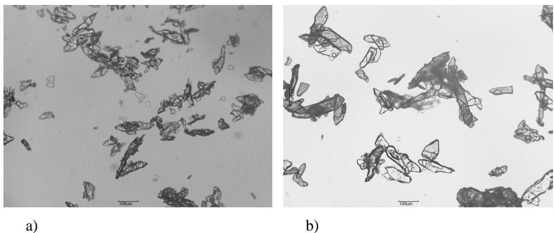
*Slika 27.* Fotografije kristala memantin hidrogen sulfata za sustav 2-propanol / n-heptan (75/25): a) brzo dodavanje n-heptana i b) dokapavanje n-heptana (uvećanje 100x)
