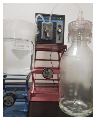
Slika 3.7. Aparatura korištena za membransku filtraciju prirodnih voda.
