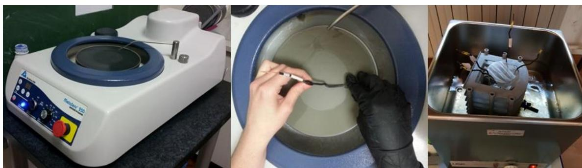
Slika 3.2. Mehaničko strojno poliranje te čišćenje uzorka u ultrazvučnoj kupelji.
