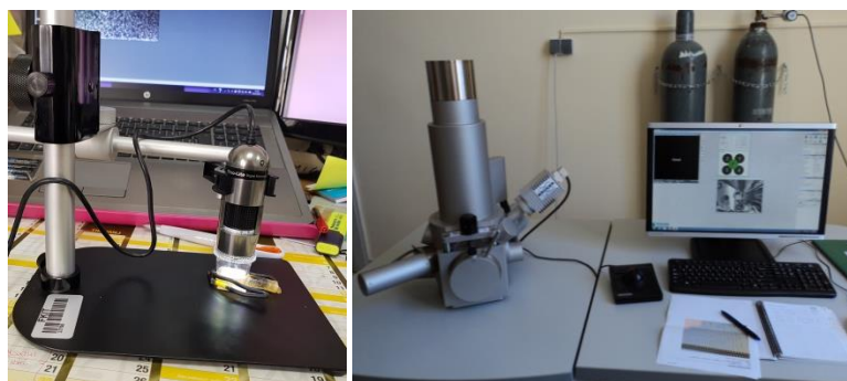
Slika 3.25. Optički (a) i pretražni elektronski (b) mikroskop.
