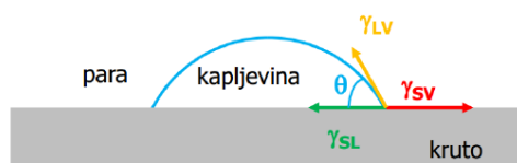
Slika 3.19. Youngov kontaktni kut na idealnoj površini.
