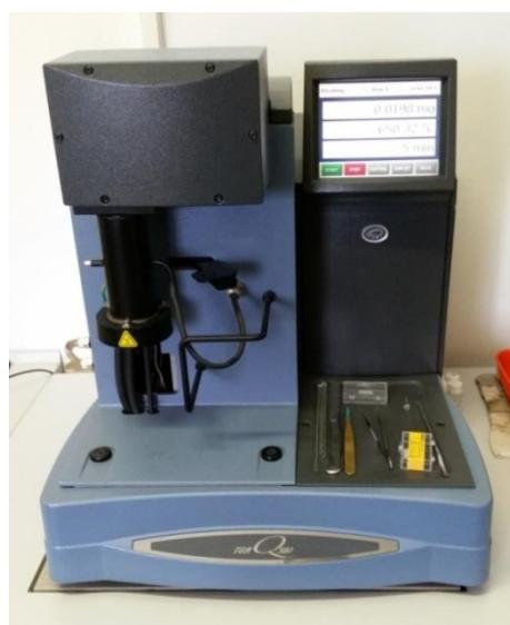
Slika 25. Uredaj za termogravimetrijsku analizu, *TA Instruments Q500*
