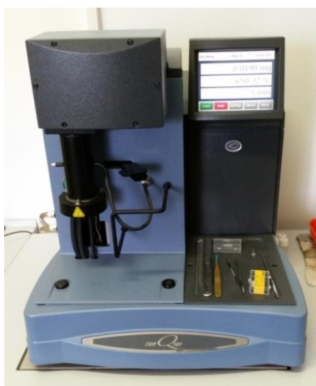
Slika 25. Uređaj za termogravimetrijsku analizu, TA Instruments Q500
