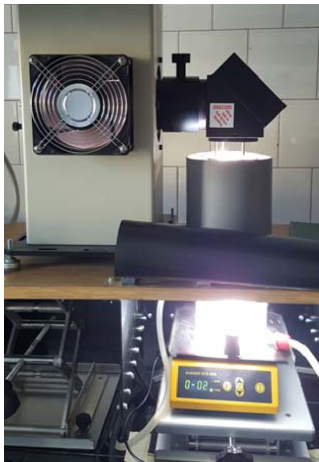
Slika 3.1. Fotoreaktor smješten pod kolimirani izvor simuliranog Sunčevog zračenja.
