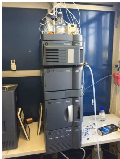
Slika 23. Tekućinski kromatograf ultra visoke djelotvornosti (Waters I-Class)
