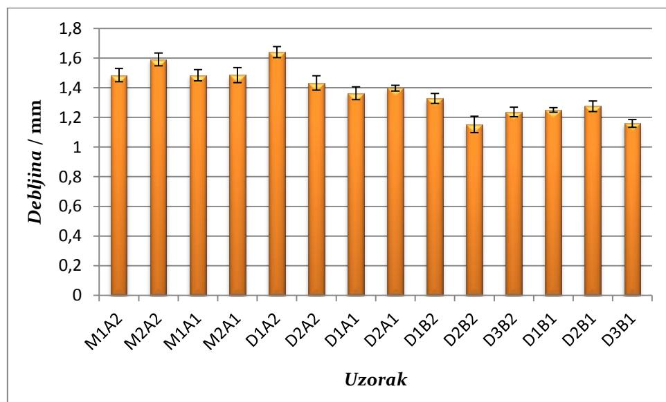
Slika 4.5. Srednje vrijednosti i standardna devijacija deblijine epruveta za kidalicu
