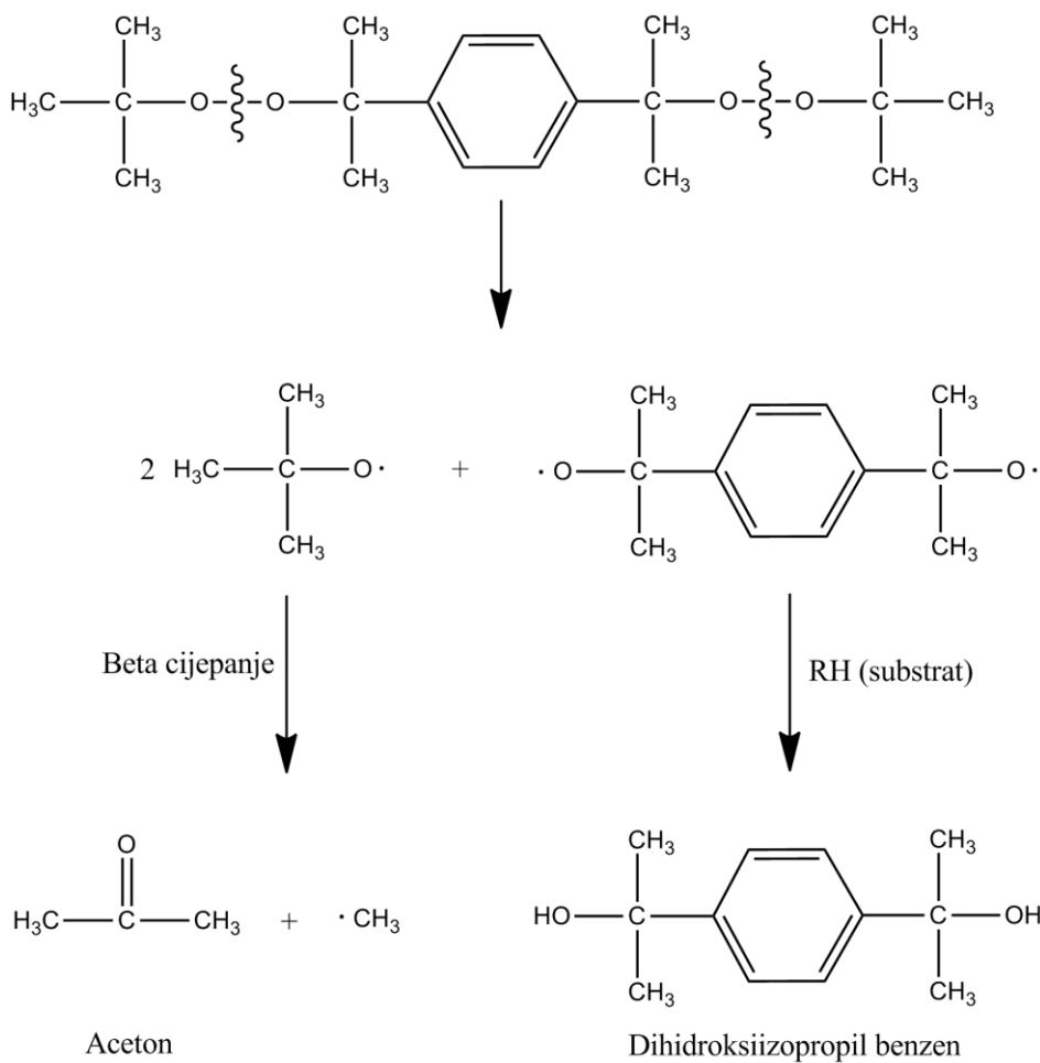
Slika 2.10. Mehanizam raspada di(tert-butilperoksiiizopropil)benzena
