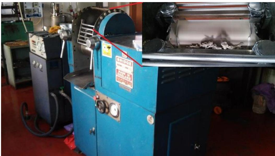
Slika 3.3. Dvovaljak za mastikaciju i umješavanje
