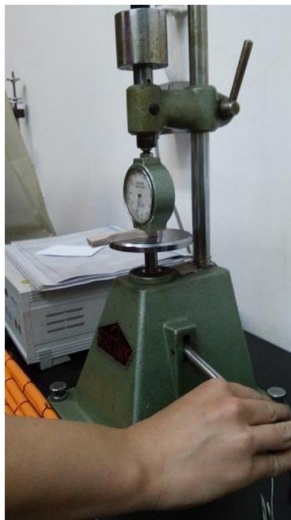
Slika 3.6. Mjerenje tvrdoće na tvrdomjeru
