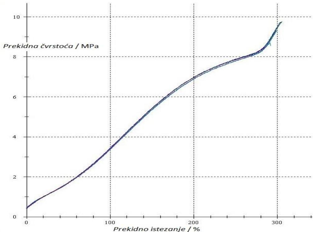
Slika 4.4. Deformacijska krivulja naprezanje-istezanje za uzorak D2A1
