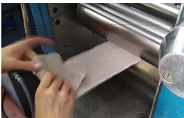
Slika 3.9. Umješavanje na dvovaljku
