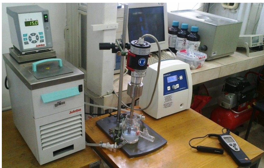
Slika 9. Aparaturu korištena za pripravljanje suspenzije nanofluida
