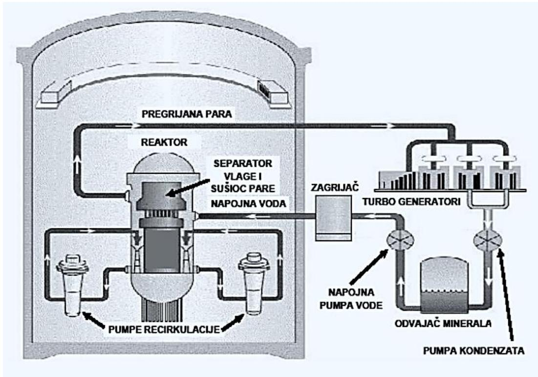
Slika 2.7. Shema ključajućeg nuklearnog reaktora BWR. [9]
