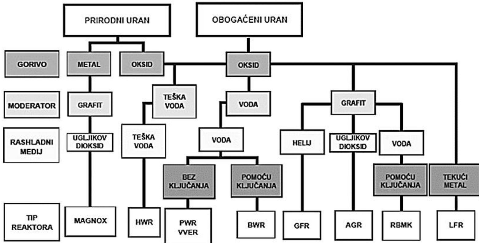
Slika 2.3. Shematski prikaz reaktora u odnosu na vrstu goriva, moderatora i rashladnog medija. [9]
