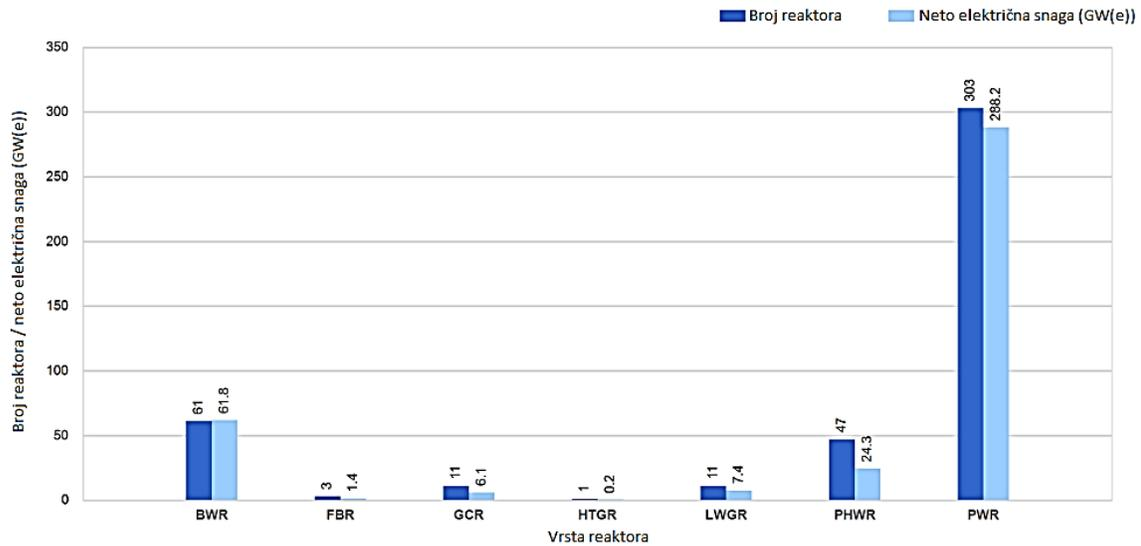
Slika 2.5. Broj pogonskih reaktora prema vrsti i neto električnoj snazi
