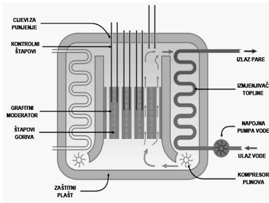
Slika 2.9. Shema poboljšanog plinskog nuklearnog reaktora AGR. [9]
