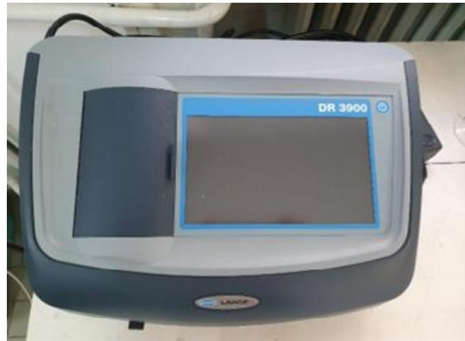
**Slika 5.** Spektrofotometar Hach Lange DR 3900
