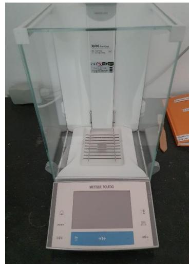
**Slika 4.** Analitička vaga XA105 DualRange, Mettler Toledo
