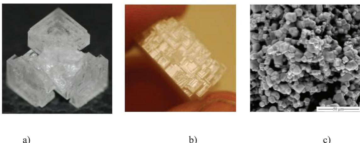
**Slika 2.** Prikaz kristala KCl-a dobivenog: a) hlađenjem b) zaledivanjem c) raspršivanjem.<sup>3</sup>
