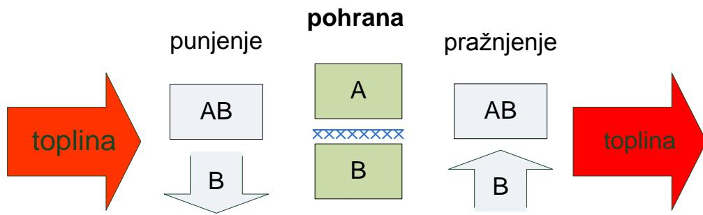
Slika 7. Shematski prikaz načela pohrane topline adsorpcijom.<sup>13</sup>
