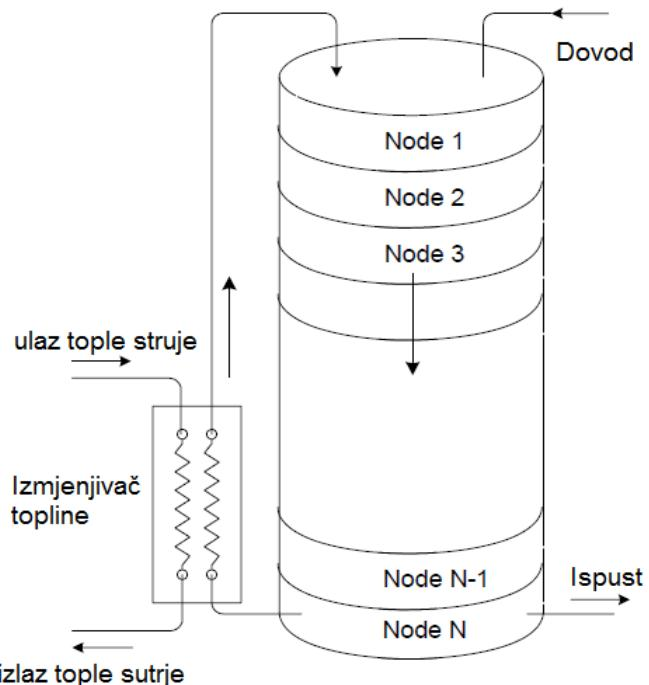
Slika 15. Model spremnika topline u programskom sustavu TRNSYS<sup>23</sup>
