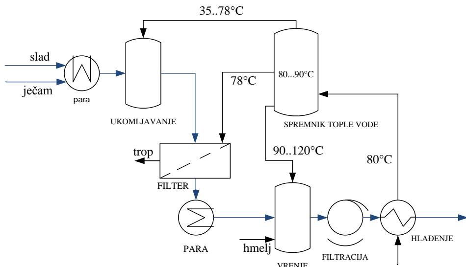
Slika 11. Procesna shema toplog dijela proizvodnje piva
