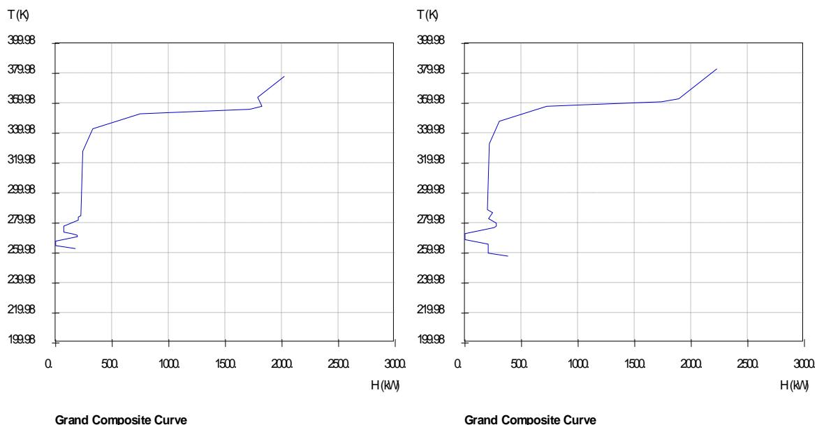
Slika 19. Velika kompozitna krivulja ( $\Delta T_{min} = 10^0 C$  i  $\Delta T_{min} = 20^0 C$ )
