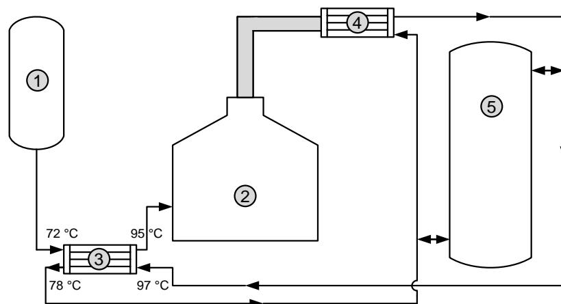
Slika 12. Shematski prikaz rekuperacije topline primjenom kondenzatora pare.<sup>20</sup>
