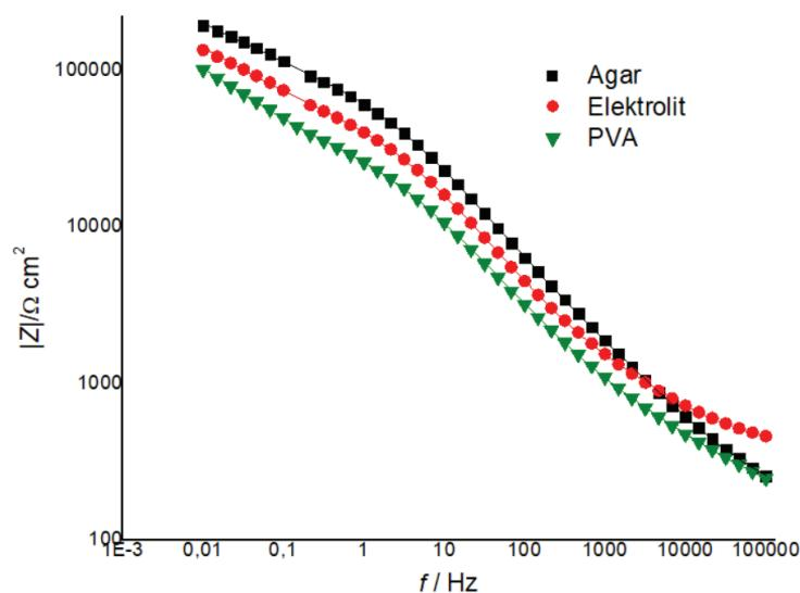
**Slika 22.** Bodeov dijagram ovisnosti absolutne vrijednosti impedancije pri različitim frekvencijama za nitratnu (zelenu) patinu s tri vrste elektrolita
