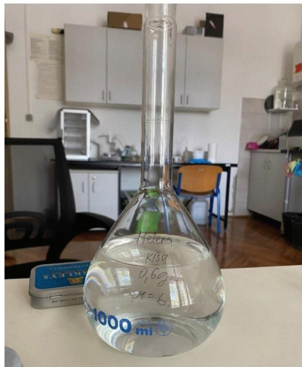
**Slika 10.** Tekući elektrolit – umjetna kiša
