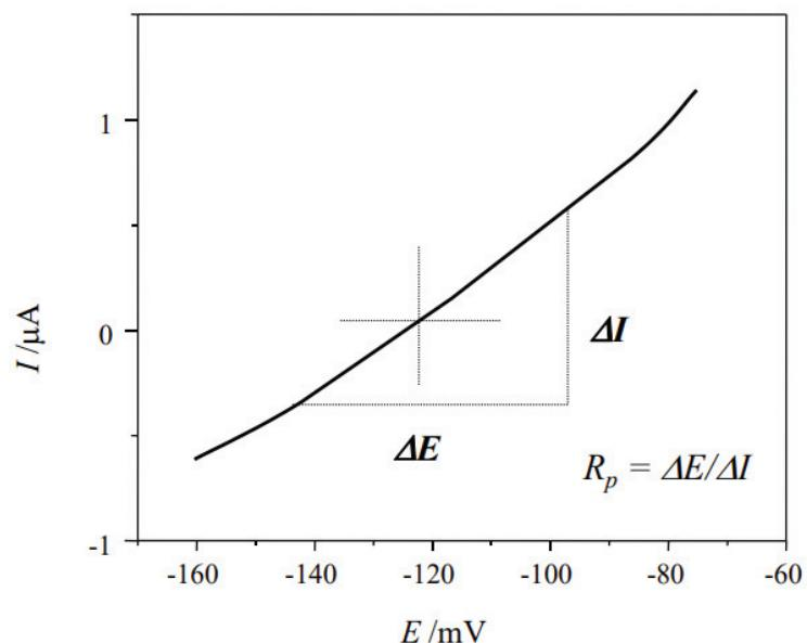
**Slika 6.** Prikaz načina izračunavanja polarizacijskog otpora,  $R_p$  [17]
