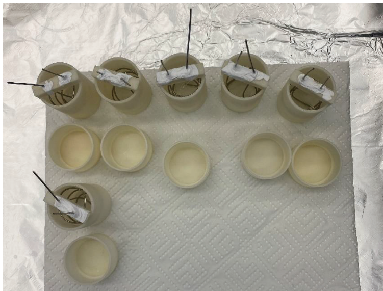
Slika 13. Elektrokemijska ćelija za PVA i agar hidrogelove
