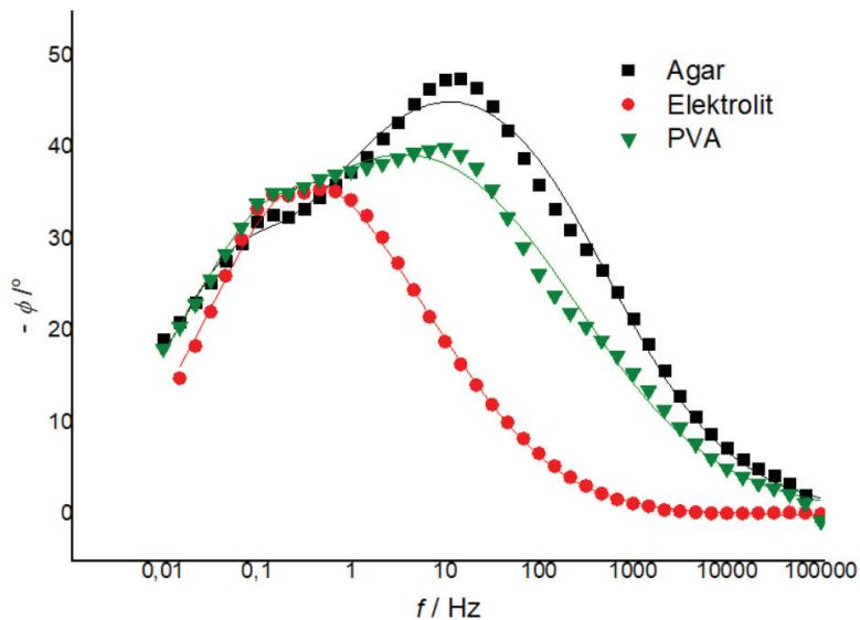
**Slika 17.** Bodeov dijagram ovisnosti faznoga kuta pri različitim frekvencijama za bakar s tri vrste elektrolita
