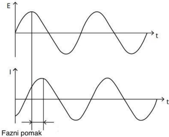
**Slika 1.** Sinusoidalni odziv struje u linearom sustavu [7]
