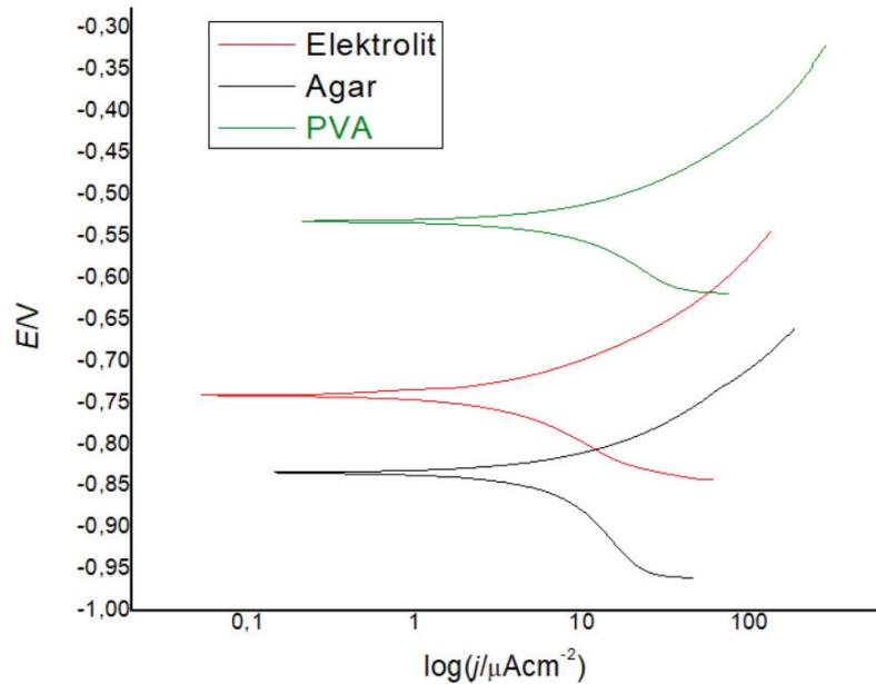
**Slika 28.** Krivulje dobivene Tafelovom polarizacijom za ugljični čelik
