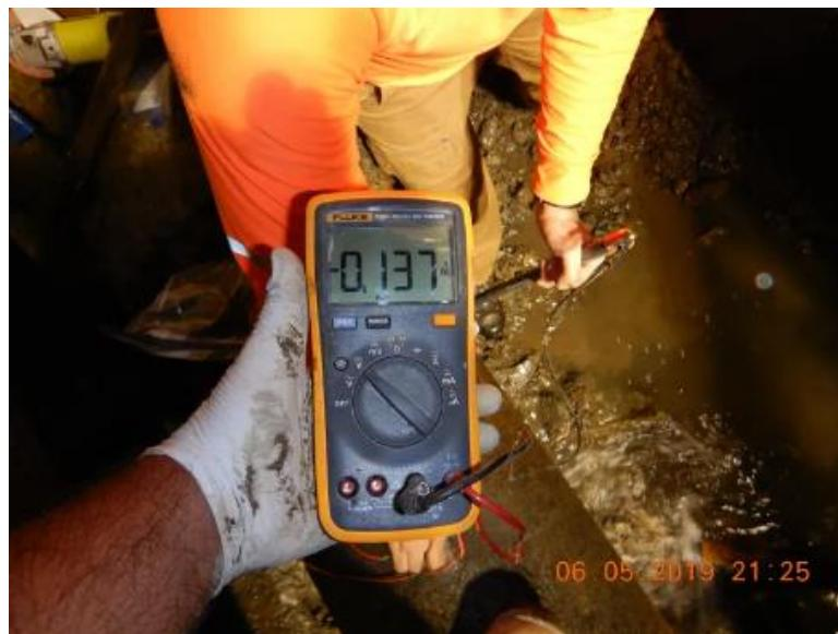
Slika 10. Mjerenje elektrokemijskog potencijala[28]
