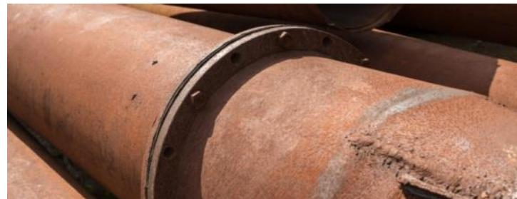
Slika 1. Primjer jednolike korozije cijevi[10]
