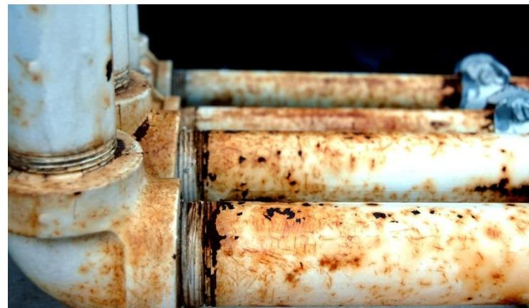
Slika 4. Primjer pukotinske korozije cijevi[8]
