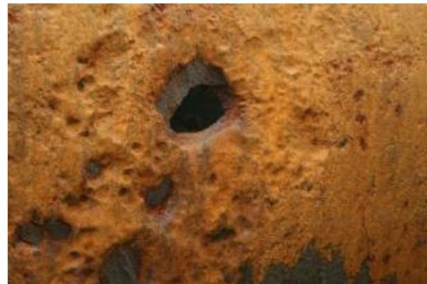
Slika 2. Primjer jamičaste korozije cijevi[12]
