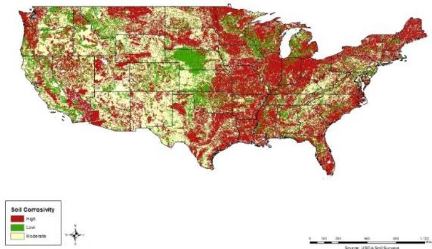
Slika 9. Primjer karte korozivnosti tla[28]
