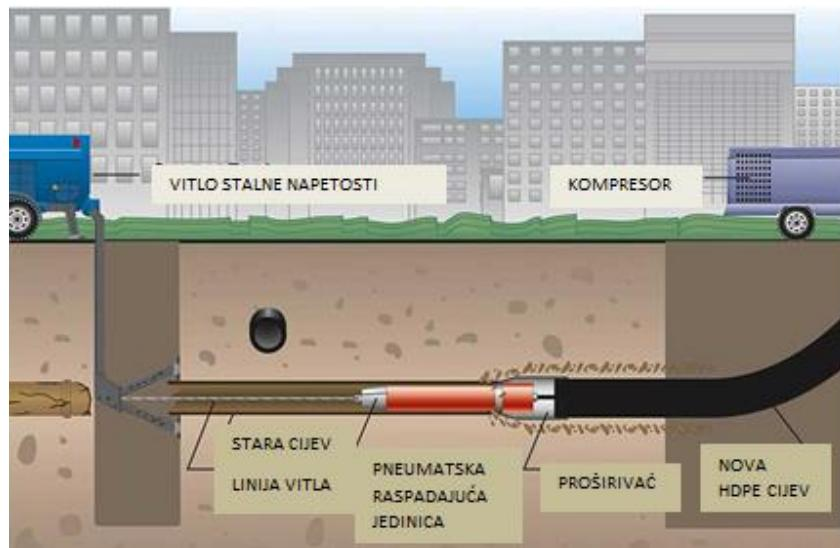
Slika 15. Prikaz zamjene vodovodnih cijevi metodom 1.[30]
