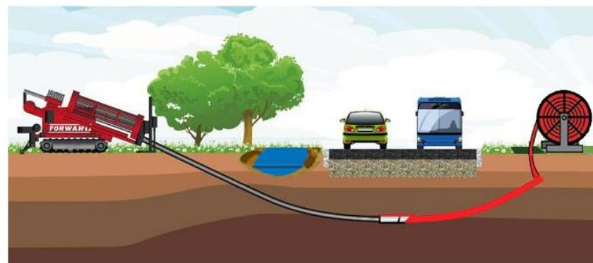
Slika 16. Prikaz zamjene vodovodnih cijevi metodom 2.[31]
