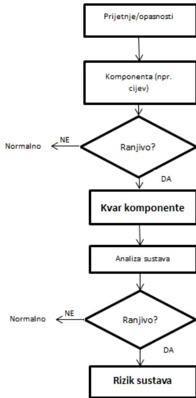
Slika 13. Dijagram općeg postupka procjene koroziskog rizika u ostarjelim vodovodima[29]
