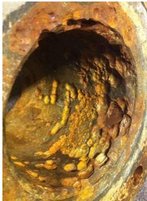
Slika 5. Primjer korozije cijevi pod mikrobiološkim utjecajem[14]
