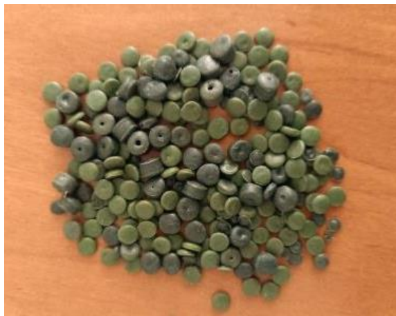
Slika 4.1.7.: Uzorak polipropilena PP-R0 – reciklat ambalažnih materijala
