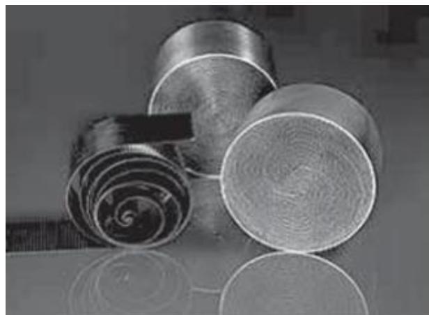
**Slika 2.4.** Priprava metalnih monolita
