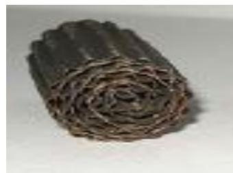
*Slika 3.5.* Metalni monolitni katalizator
