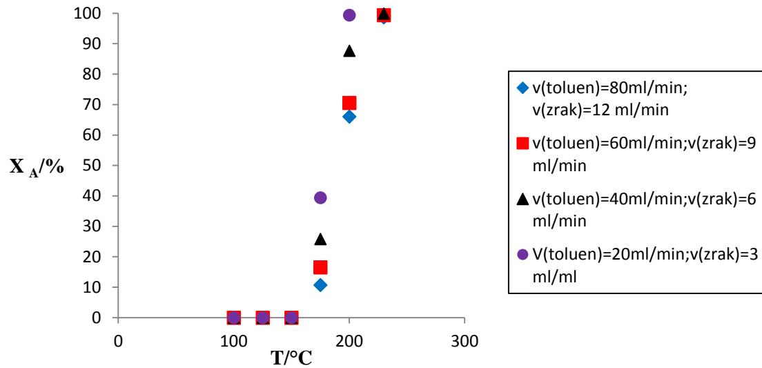
**Slika 5.2.** Utjecaj temperature na konverziju toluena pri različitim prostornim vremenima i stalnim omjerima volumnih protoka reaktanta i oksidansa,  $v_0(\text{toluen}):v_0(\text{zrak})=20:3$ .
