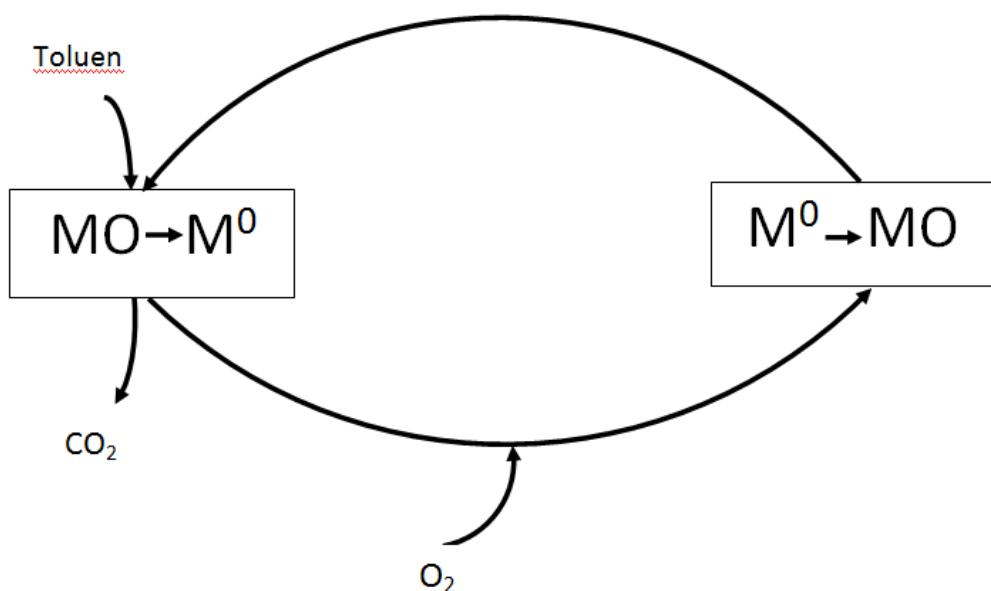
*Slika 2.6.* Shematski prikaz Mars van Krevelenovog mehanizma
