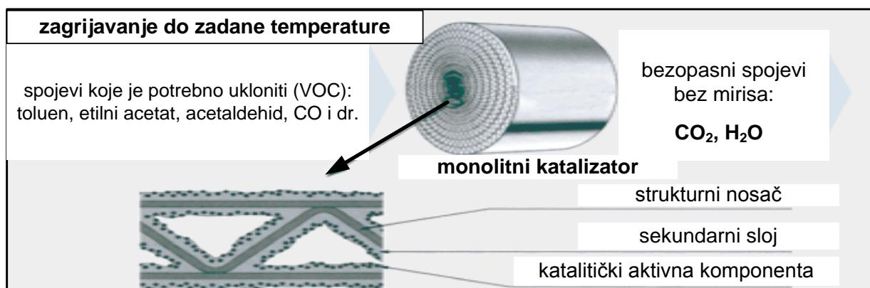
*Slika 2.2. Katalitička oksidacija VOC na metalnom monolitu*
