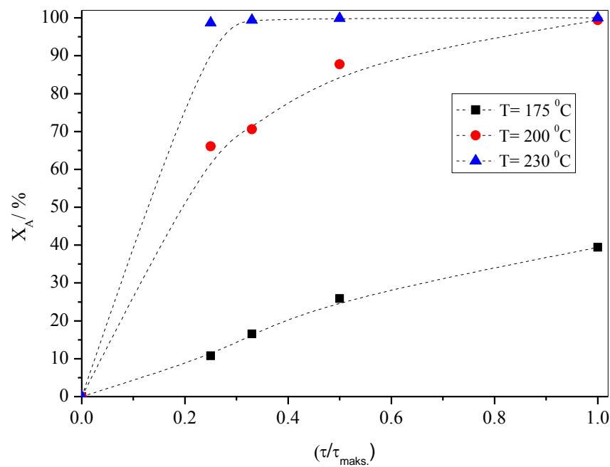
**Slika 5.3.** Utjecaj temperature i normaliziranog prostornog vremena na konverziju toluena pri stalnim omjerima volumnih protoka reaktanta i oksidansa,  $v_0(\text{toluen}):v_0(\text{zrak})=20:3$ .
