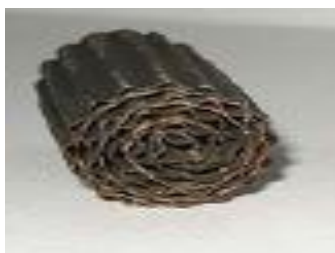
Slika 3.5. Metalni monolitni katalizator
