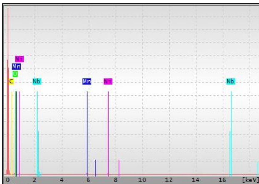
Slika 4.3. Rezultati EDX analize Mn-Ni katalizatora.
