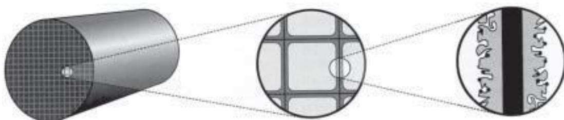
*Slika 2.3.* Shematski prikaz keramičkog monolitnog katalizatora
