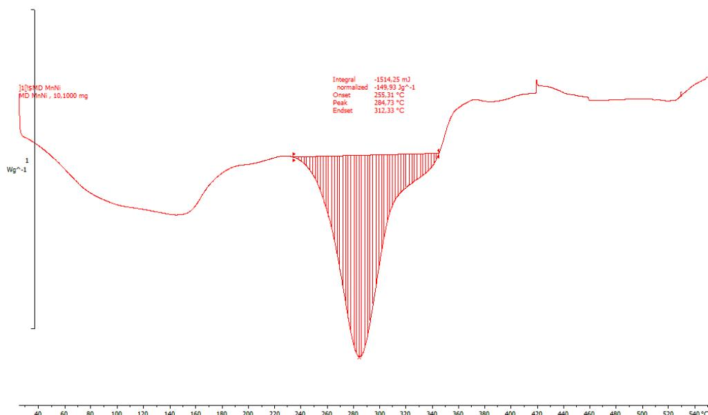
**Slika 4.5.** Rezultati DSC analize uzorka katalizatora Mn-Ni
