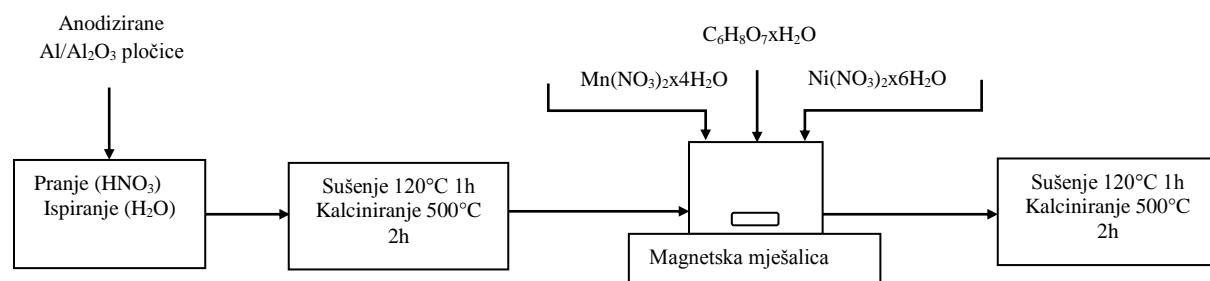
*Slika 3.3. Shematski prikaz pripreme metalnog monolitnog katalizatora*
