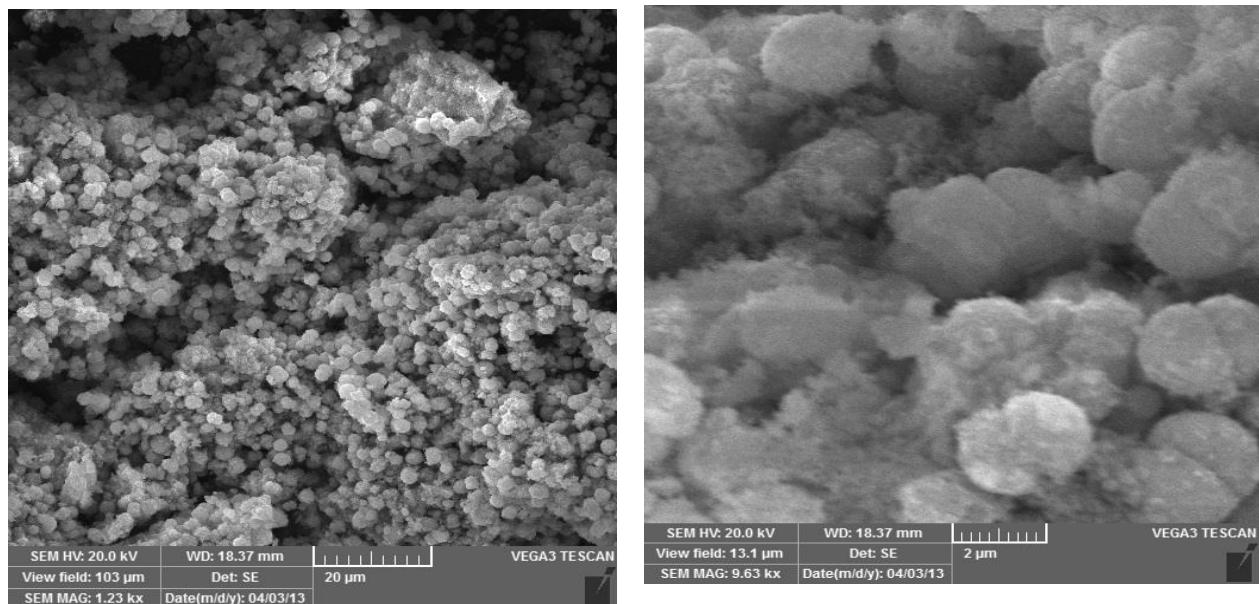
**Slika 4.1.** Rezultati analize katalizatora dobiveni primjenom pretražne elektronske mikroskopije (SEM) pri različitim uvećanjima.
