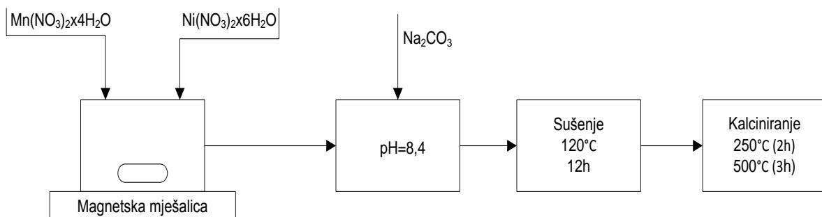
*Slika 3.1.* Shematski prikaz pripreme praškastog Mn-Ni katalizatora
