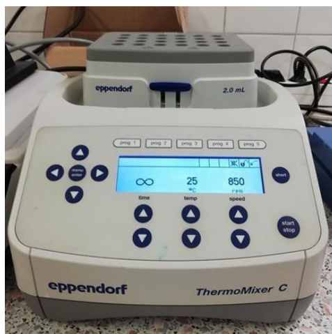
Slika 12. Termostatirana tresilica Eppendorf ThermoMixer C
