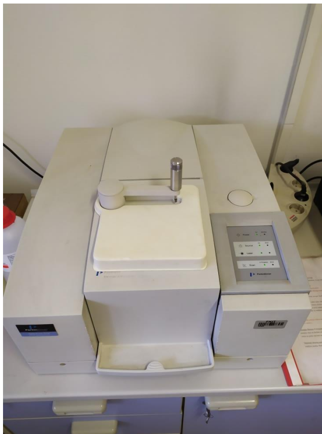
Slika 19. Uređaj za FTIR, Perkins Elmer Spectrum One
