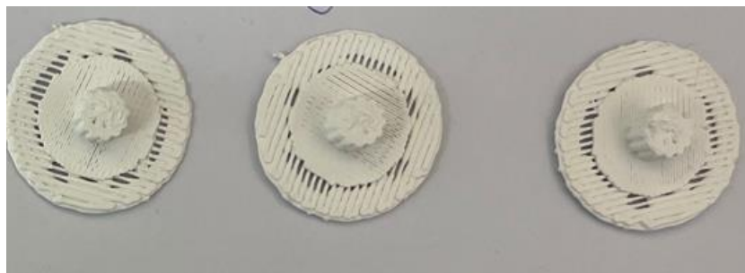
Slika 19. 3D-ispisani model korištenjem PS postavki ispisa (s lijeva na desno): -20 %, -40 %, -50 %
