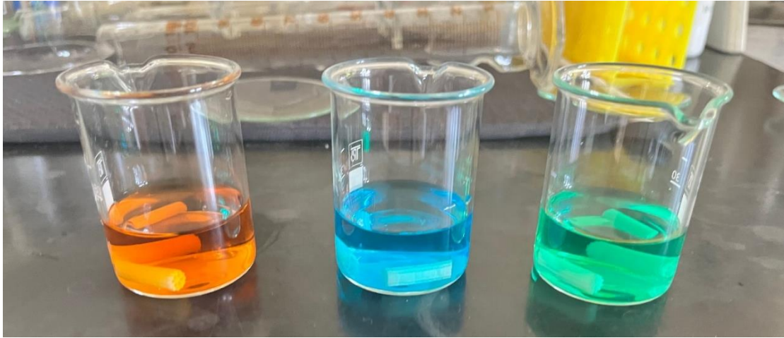
Slika 12. Impregnacija monolitnih nosača katalizatora u otopinama (s lijeva na desno) Mn i Fe, Mn i Cu te Mn i Ni
