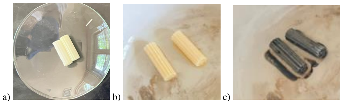
Slika 26. Monolitni nosač katalizatora ZDP geometrije: a) prije impregnacije b) nakon impregnacije u otopini Mn i Fe c) nakon kalciniranja
