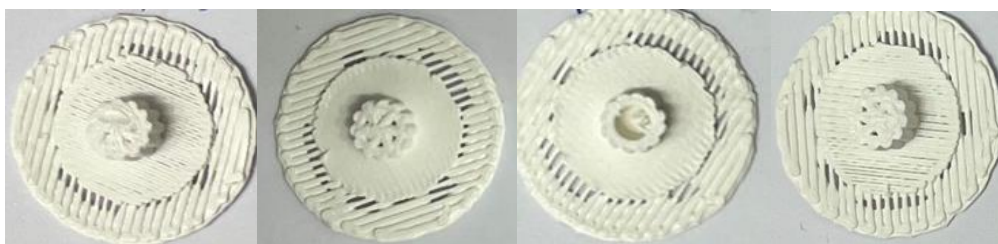
Slika 21. 3D-ispisani model korištenjem LT postavki ispisa (s lijeva na desno): 0,09 mm, 0,19 mm, 0,29 mm, 0,39 mm
