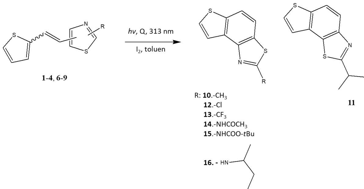
Shema 3: Elektrociklizacijski reakcijski put sinteze tienobenzo-tiazola **10-16**.
