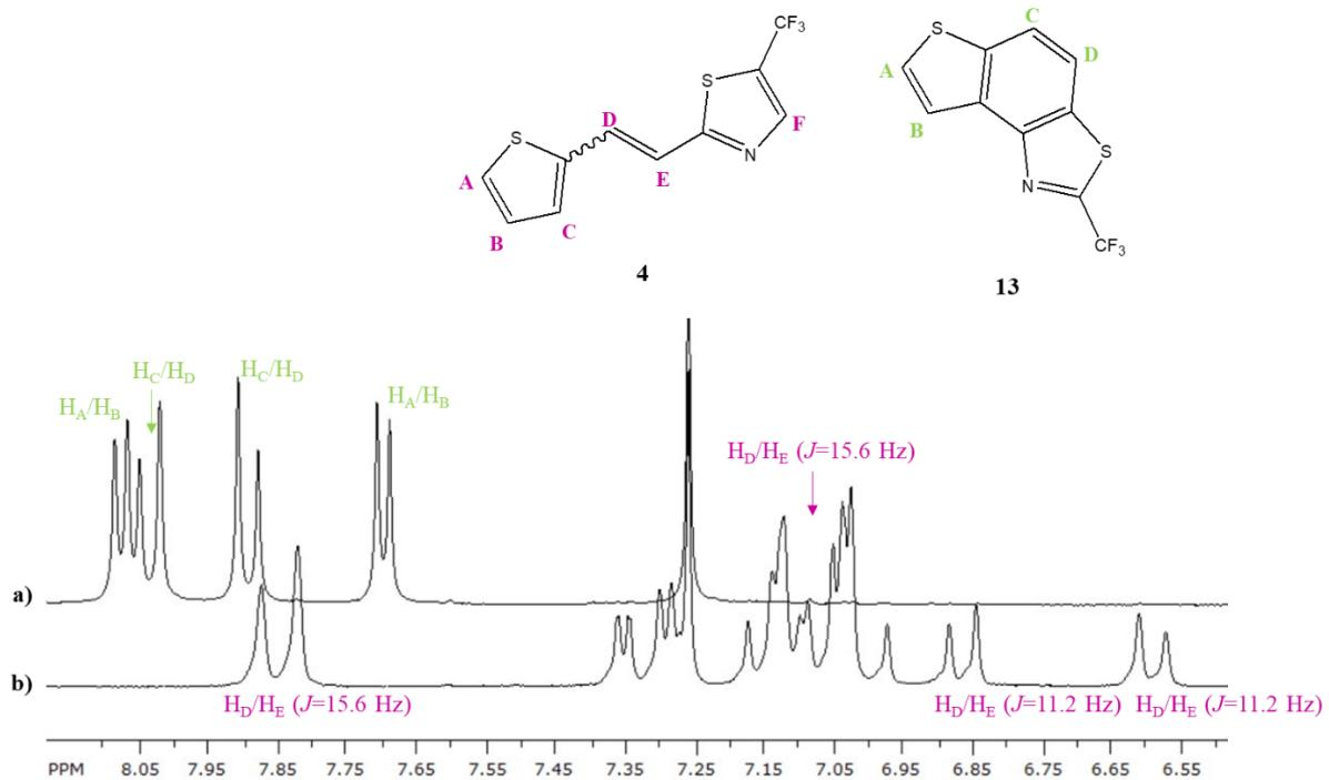
Slika 6:  $^1\text{H}$  NMR spektri i strukture tienobenzo-tiazola **13** (a) i smjese izomera 1,3-tiazolo-tienostilbena **4** (b).
