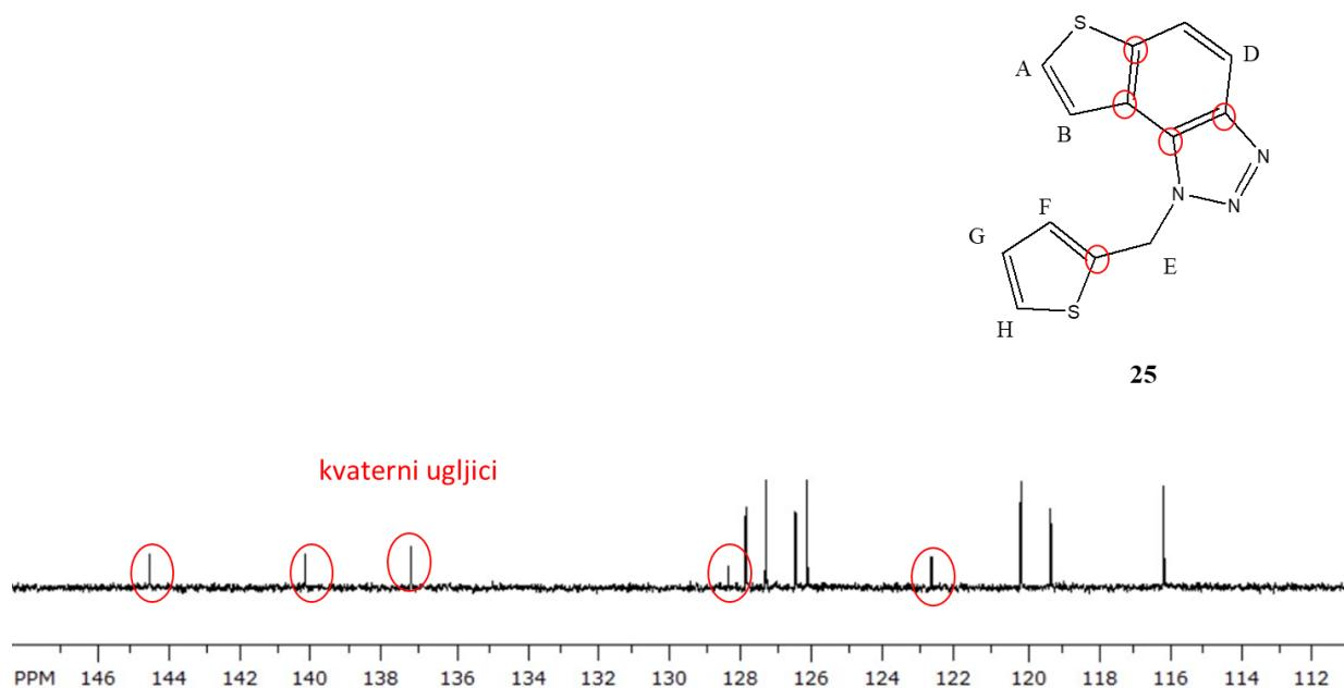
Slika 18:  $^{13}\text{C}$  NMR spektar triazolnog elektrociklizacijskog fotprodukta **25** s istaknutim kvaternim ugljicima.
