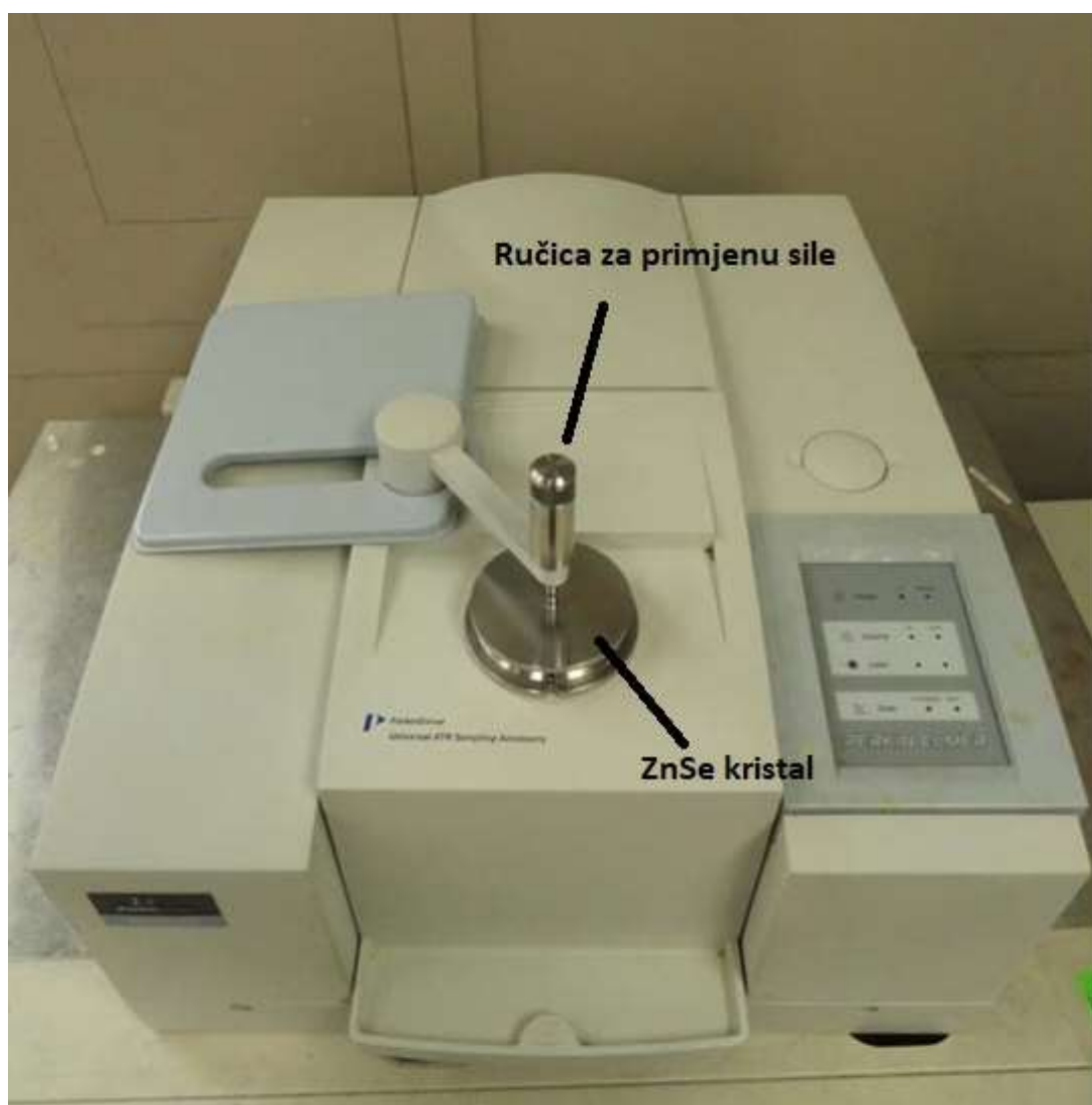
Slika 9. Perkin Elmer Spectrum One FT-IR Spectrometer
