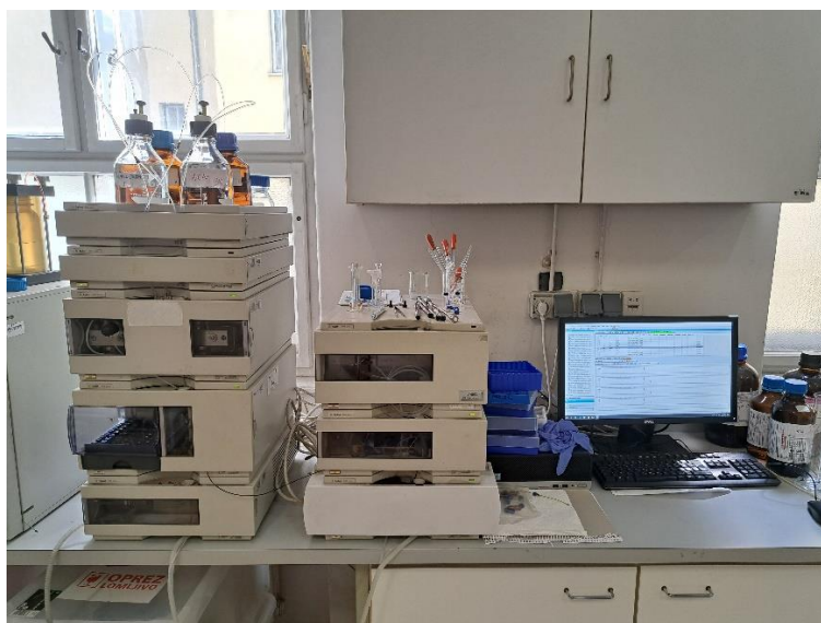
Slika 11. HPLC-DAD kromatograf Agilent 1100 Series
