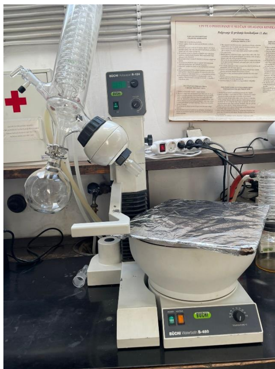
Slika 8. Rotacijski uparivač Buchi Rotavapor R-124 i vodena kupelj Buchi Waterbath B-480
