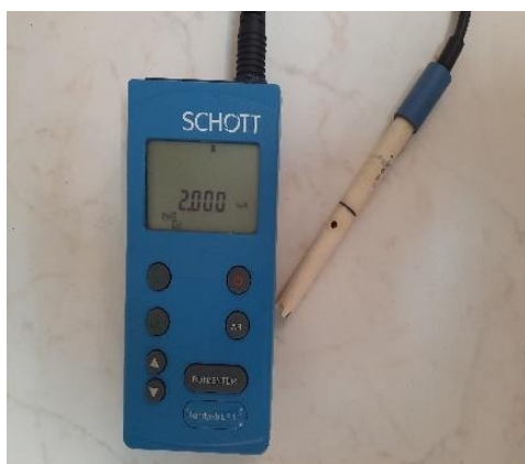
Slika 16. pH metar Handylab Ph11 .
