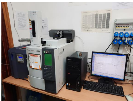
Slika 17. Plinski kromatograf GC-2014, Shimadzu
