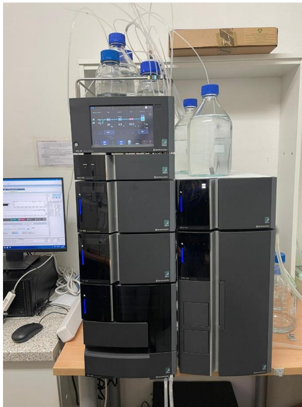
Slika 7. HPLC uređaj (LC-40 Nexera Lite (Shimadzu, Japan))
