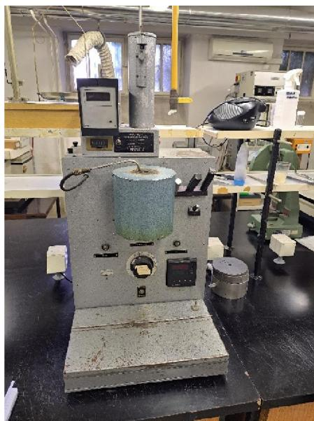
**Slika 3.3.** Uređaj za mjerjenje brzine protjecanja taljevine Ceast MFI, Instron, USA
