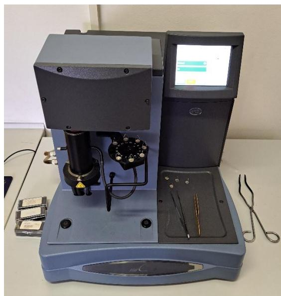
**Slika 3.4.** Termogravimetar TGA Q500, TA Instruments, USA
