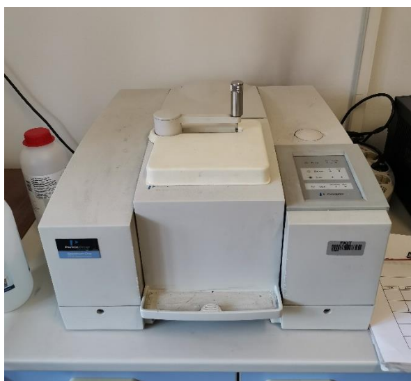
Slika 3.4 Spectrum One Perkin-Elmer spektrometar.
