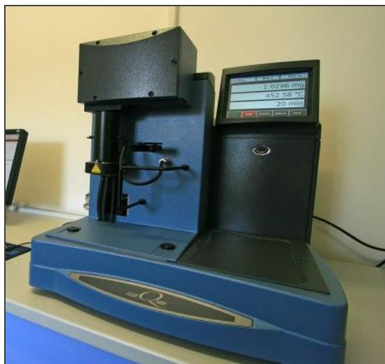
**Slika 28.** Termogravimetar, TA Instruments Q500
