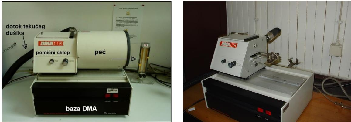
**Slika 27.** Dinamičko-mehanički analizator 983, TA Instruments
