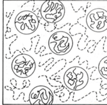
Slika 5. Morfologija nemješljive mješavine polimera A (puna linija) i polimera B (iscrtkana linija) 6
