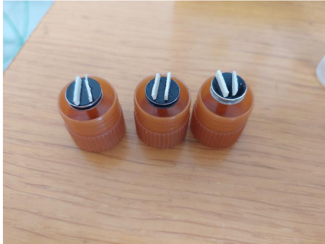
Slika 31. Pripremljeni uzorci za SEM analizu
