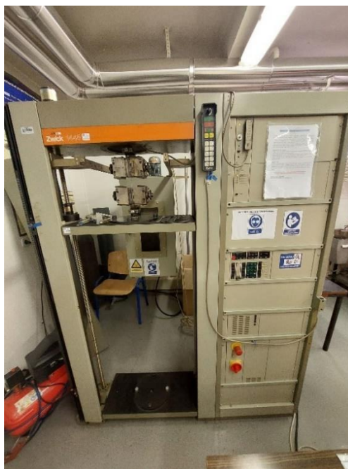
Slika 32. Univerzalna mehanička kidalica Zwick 1445
