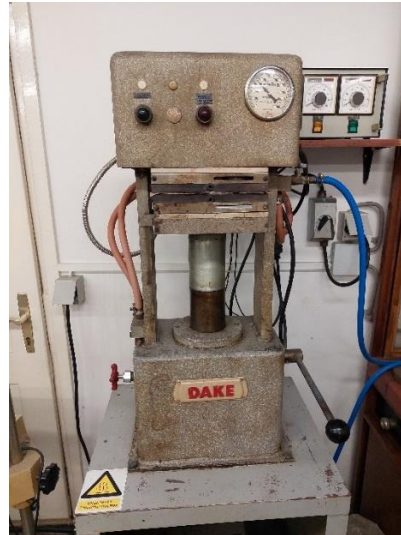
Slika 28. „Fontune“ preša (lijevo) i „Dake“ preša (desno)
