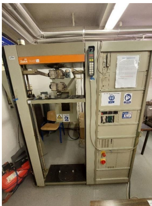
Slika 32. Univerzalna mehanička kidalica Zwick 1445
