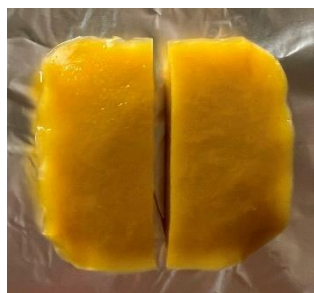
Slika 73. Prereznani uzorak hidrogela s pročišćenom peludi
