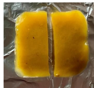
Slika 74. Prereznani uzorak hidrogela s nepročišćenom peludi
