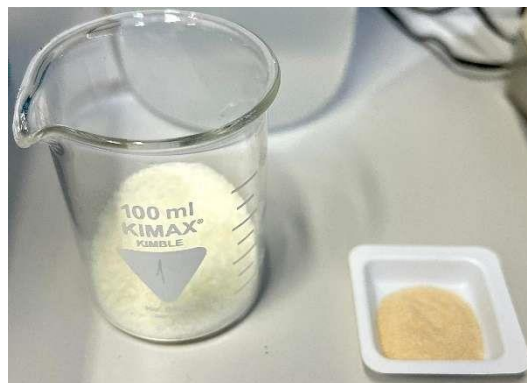
Slika 11. Komponente za pripremu hidrogelova: poli(vinil-alkohol) (lijevo) i natrijev alginat (desno)
