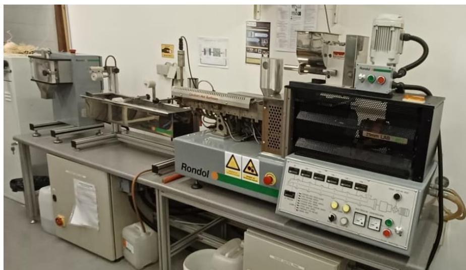
**Slika 22.** Dvopužni laboratorijski ekstruder, Randol Bench Top 21
