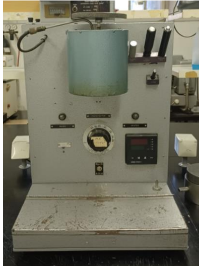
Slika 24. Uređaj za mjerenje MFR-a (Ceast MFI)
