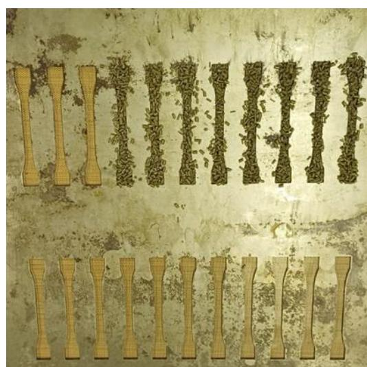
**Slika 26.** Uzorci PP stavljeni u kalup za prešanje
