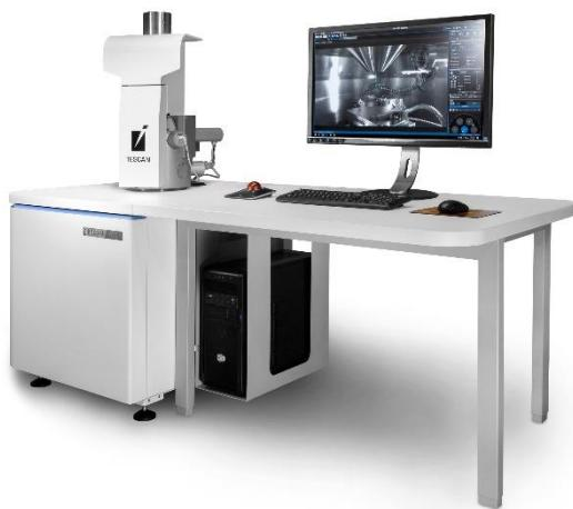
**Slika 25.** Skenirajući elektronski mikroskop (SEM), Tescan Vega 3
