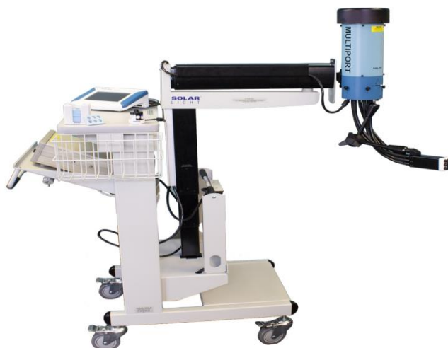
Slika 29. Prikaz korištenog solarnog simulatora 51
