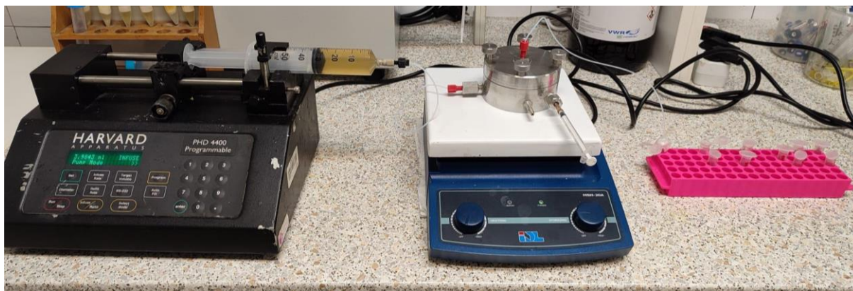
Slika 8. Aparatura potrebna za provedbu reakcije fermentacije pomoću membranskog reaktora
